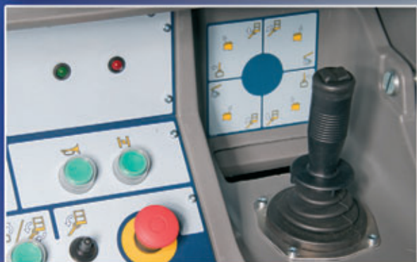
Portaaton yksivipuohjaus – takaa nostimen tarkan hallinnan.
